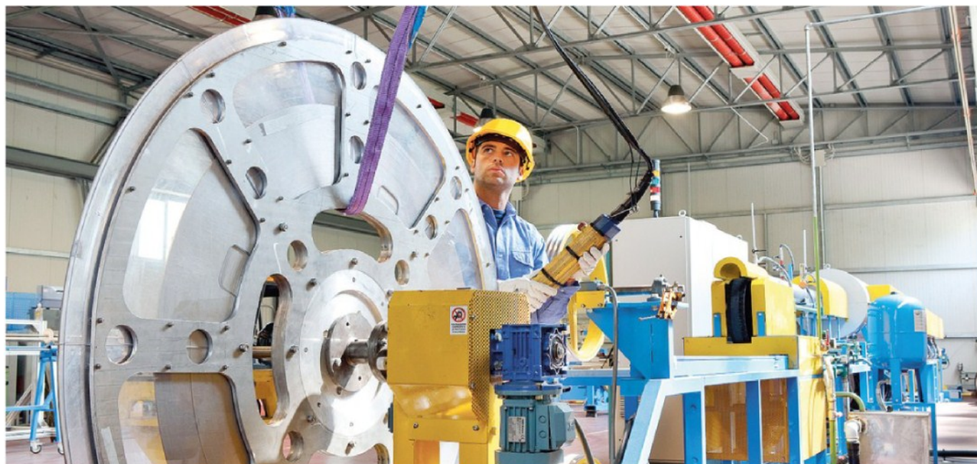
In produzione. Una fase della realizzazione del filo superconduttivo in diboruro di magnesio presso la Columbus Superconductors (gruppo Asg) di Genova
